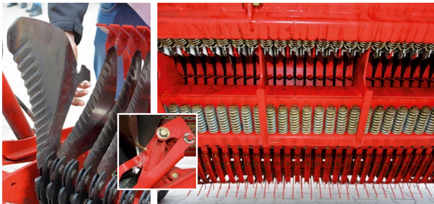
W trakcie codziennej obsługi należy kontrolować stan noży tnących (1) oraz stopień zanieczyszczenia zabezpieczeń przeciwprzeciążeniowych (2). Odległość noży od rury rotora powinna wynosić ok. 20 mm. W razie potrzeby korekty ustawień dokonuje się za pomocą śrub regulacyjnych (3).
