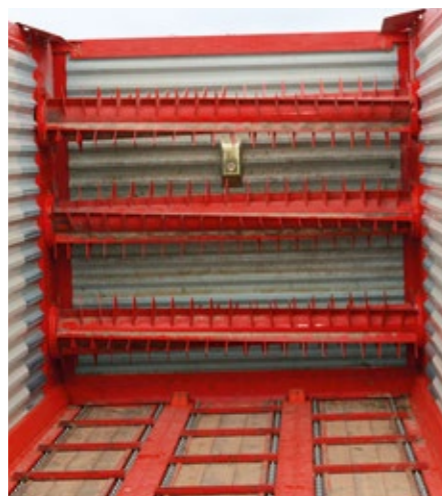
Trzy wałki dozujące zapewniają równomierny rozkład materiału w przymach.
