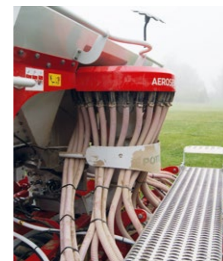
W siewnikach Aerosem zastosowano głowicę rozdzielającą nasiona do redlic z systemem IDS.
