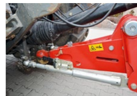
Przed rozpoczęciem pracy należy sprawdzić poprawność sprzęgu (zabezpieczenia i blokady, brak luzów i uszkodzeń) oraz połączeń hydraulicznych i elektrycznych (1). Trzeba regularnie kontrolować ciśnienie powietrza w oponach oraz stopień dokręcenia nakrętek kół (2).
