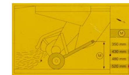
Wysokość dyszla łamanego ustawia się, obracając tłokiem siłownika (1). Odległość od środka osi obrotu ramienia koła podporowego do podłoża powinna być równa wartości podanej na tabliczce informacyjnej (3).
