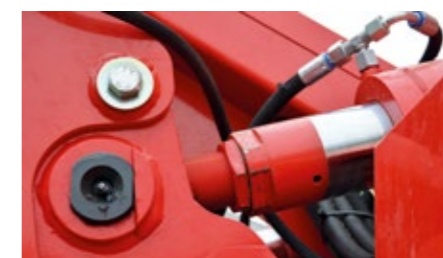
Wysokość dyszla łamanego ustawia się, obracając tłokiem siłownika (1). Odległość od środka osi obrotu ramienia koła podporowego do podłoża powinna być równa wartości podanej na tabliczce informacyjnej (3).
